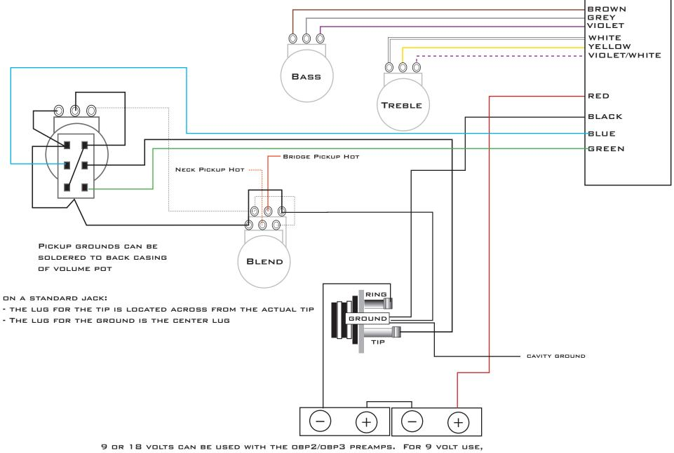
CONNECT THE NEGATIVE FROM THE BATTERY TERMINAL TO THE RING ON THE JACK.
